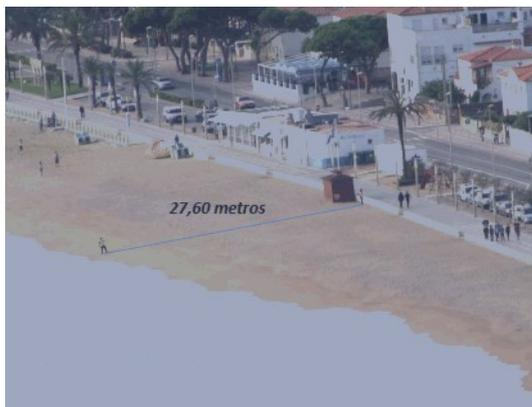
En este caso se trazó una línea perpendicular a partir del posicionamiento de dos compañeros en un extremo y otro del ancho de playa (ver Imagen 4) y se calibró utilizando distancias reales del
